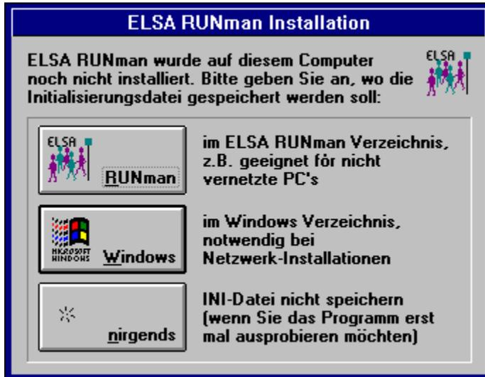
Die Information hierfür wird in der Datei WIN.INI im Windows-Verzeichnis unter dem Eintrag **RUNman** abgespeichert und kann dort notfalls noch geändert werden.
